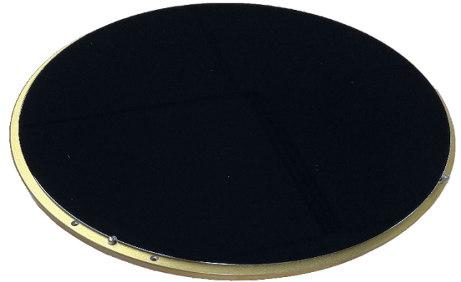
图 2. 用于应力测量的通用载台上的 200 毫米晶片。载台外围可以看到两个定位销，晶圆放置于三个支撑销钉（图中未显示）的顶部。
